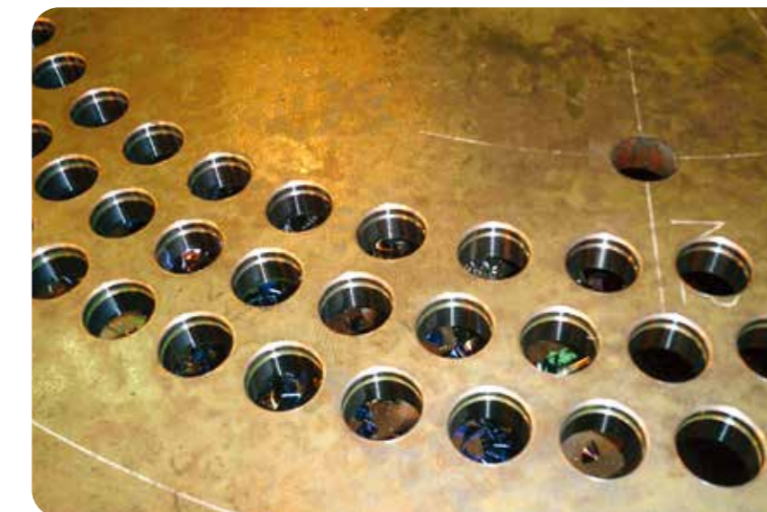
孔明後のワーク (ボイラ用管板)
