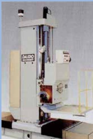
製缶構造物の接合端面、開先加工などの表面加工を行う専用機です。
